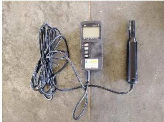
Figura 4 - Medidor de oxigênio dissolvido
