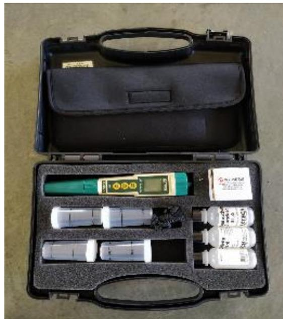
Figura 5 - Medidor de pH
