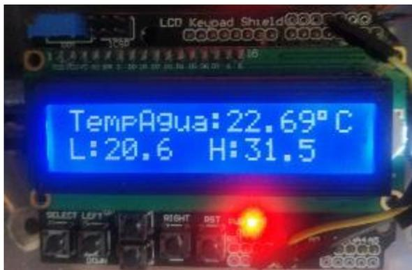
Figura 8 - Módulo sensor de temperatura da água
