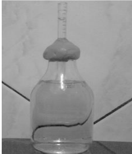
Figura 3 - Foto do Termoscópio confeccionado na oficina
